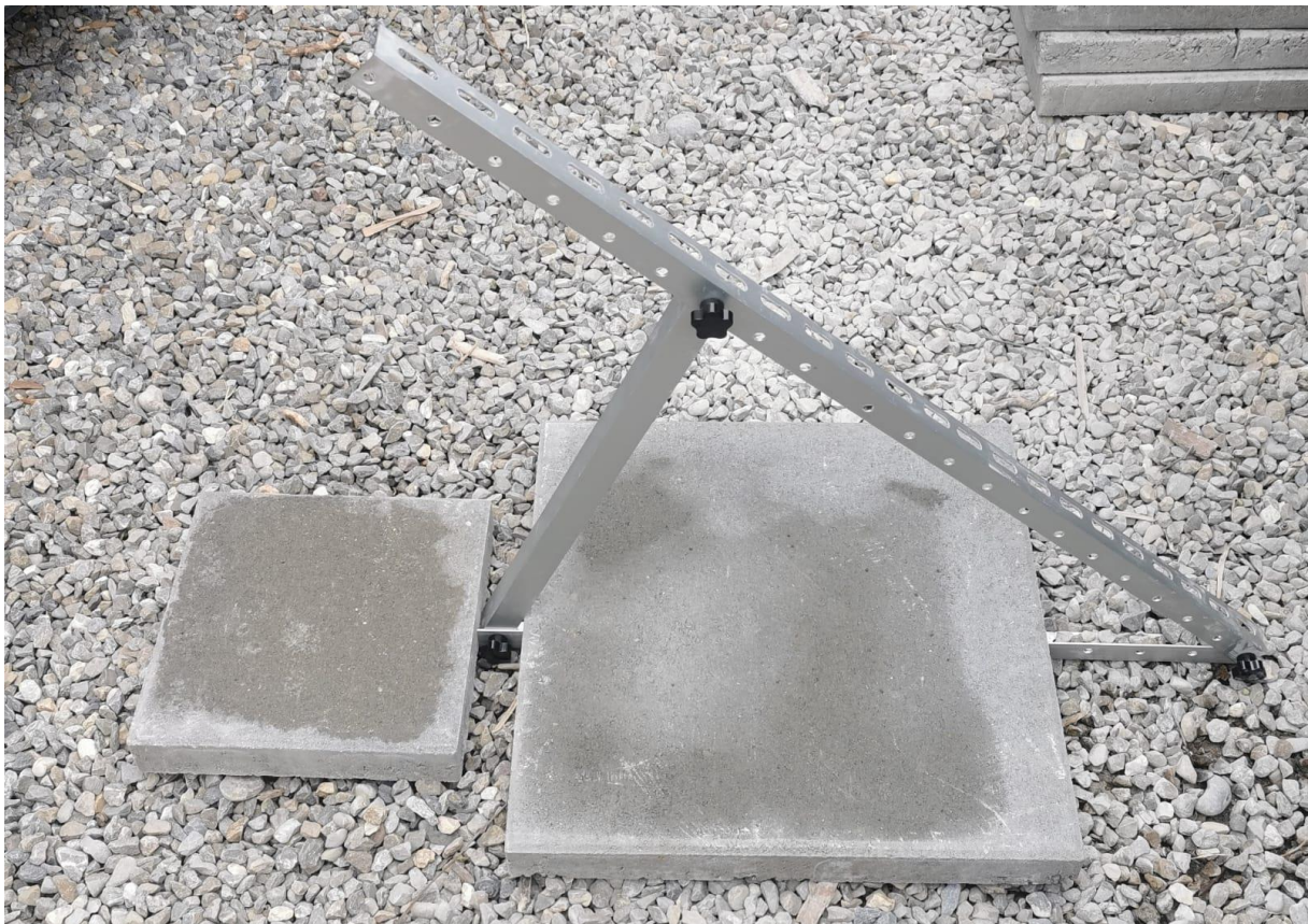
Abbildung 10: Aufständerung Mainau im Anstellwinkel von 44° im 7. Loch, Ausrichtung gegen Süden
