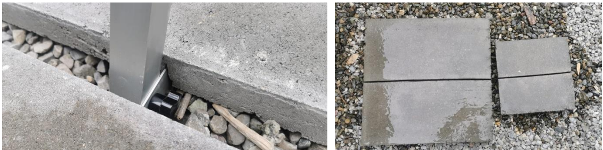
Abbildung 11: Detailaufnahmen der vorgeschlitzten Ballastiersteine aus Beton
