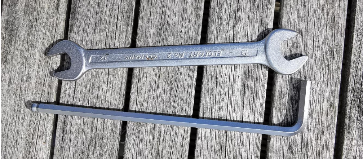
Abbildung 3: Für die Montage wird nur ein 6er Inbusschlüssel benötigt
